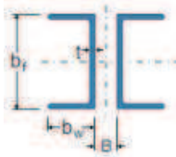
2 U laminado de abas paralelas opostos pelas almas
